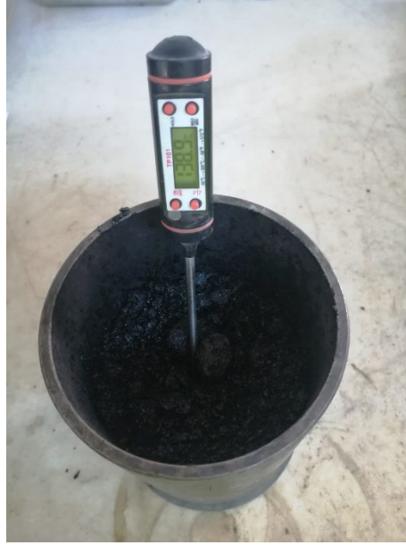
Şekil 4-3. Numunenin ısı kontrolü.
