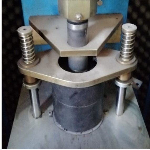
Şekil 4-7. Marshall numunelerinin sıkıştırılması işlemi.
