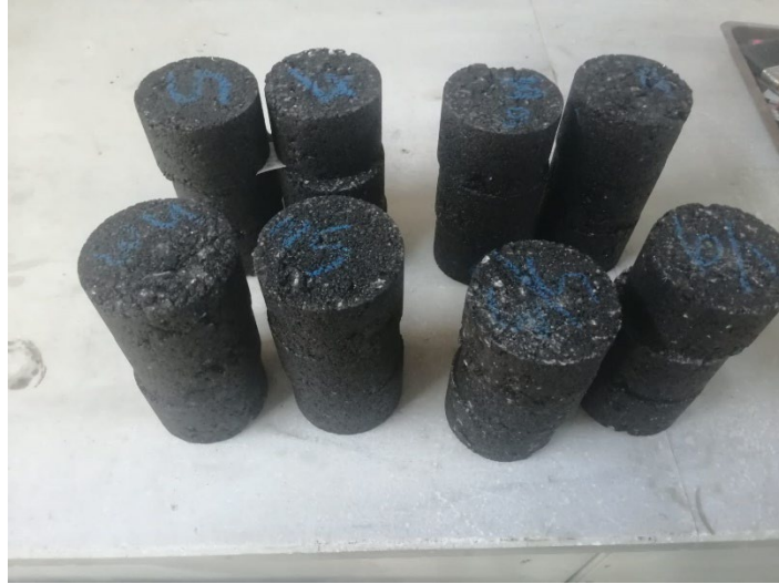
Şekil 4-8. Numunelerin kalıptan çıkarılması.
