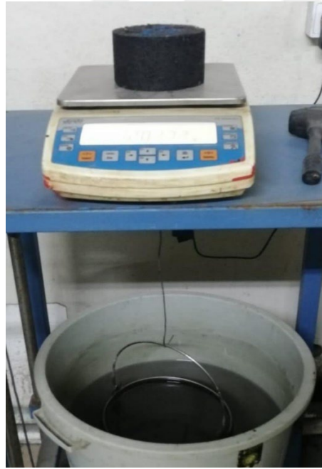
Şekil 4-10. Marshall numunelerin tartılması.
