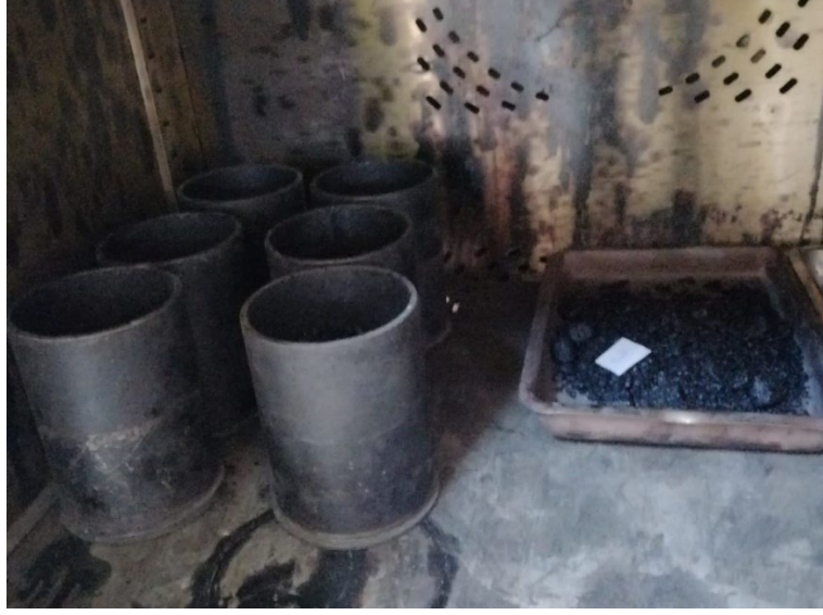
Şekil 4-5. Numunelerin etüvde bekletilmesi.
