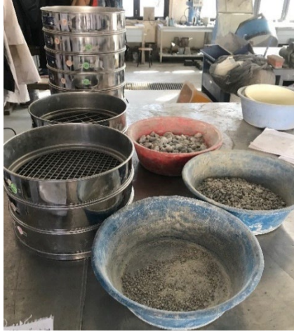
Şekil 3-1. Agregta numunelerinin ve elek takımlarının hazırlanma aşaması ve 0-4 mm çaplı agreganın eleme işlemi.
