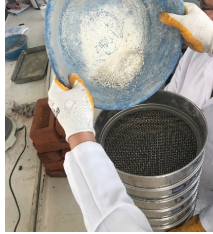
Şekil 3-1. Agregta numunelerinin ve elek takımlarının hazırlanma aşaması ve 0-4 mm çaplı agreganın eleme işlemi.
