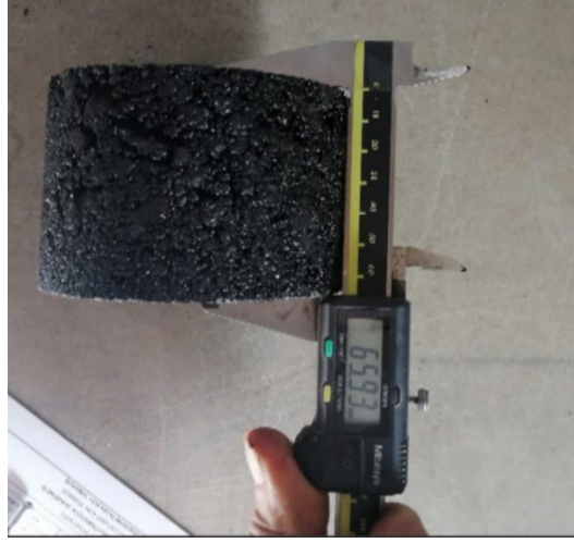
Şekil 4-9. Marshall numunesi boy ölçümü.
