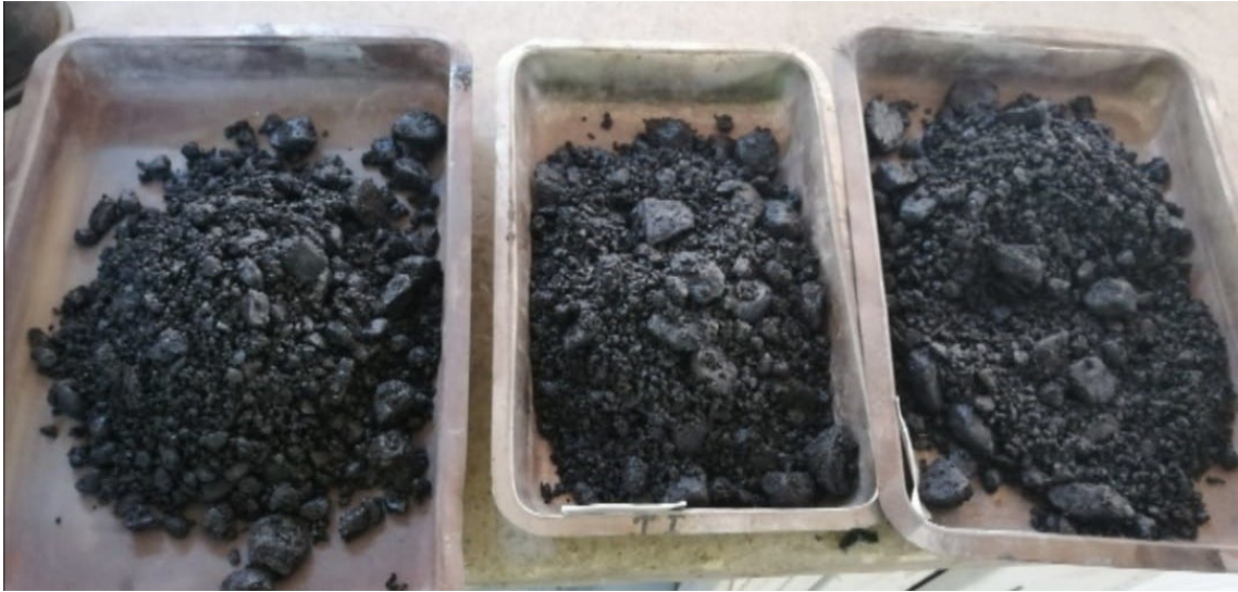
Şekil 4-2. Agregalar ve bitümün karıştırılması.
