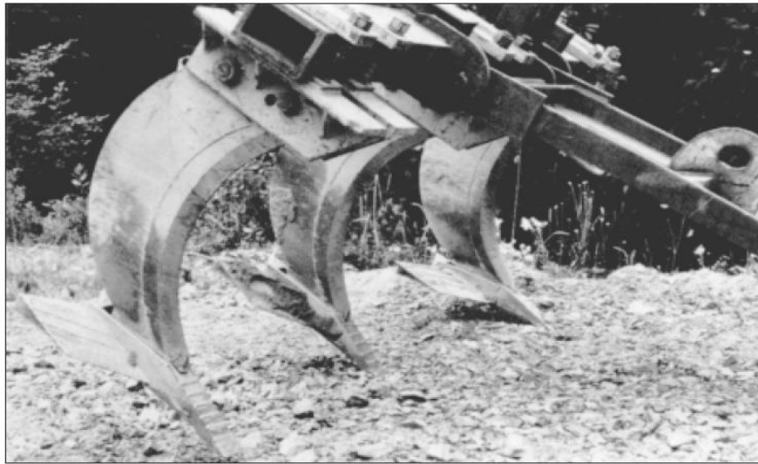
Şekil 1.3 Üretim sonrası sürütme şeridi toprağının ripperle karıştırılması [32].
