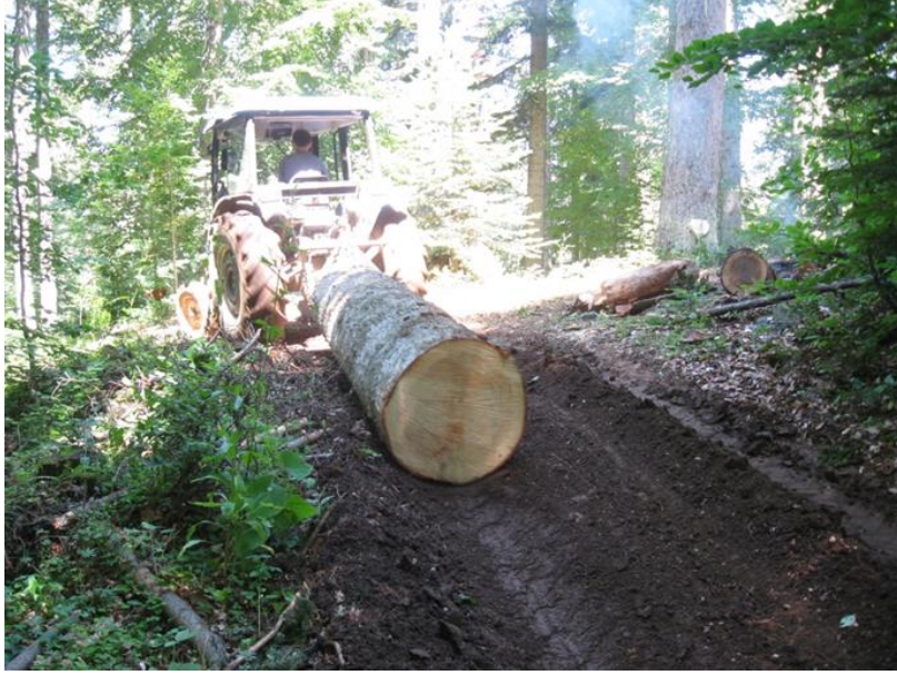
Şekil 1.1. Sürütme şeritleri üzerinde tarım traktörüyle bölmeden çıkarma yöntemi.
