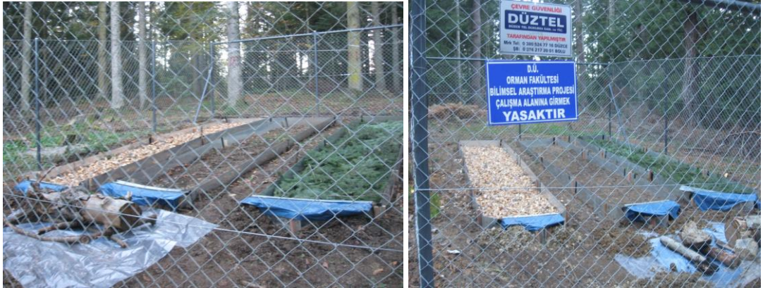
Şekil 2.4. Kuzey ve Güney bakıdaki sürütme şeritlerine yüzeysel akış parsellerinin kurulması
