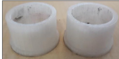
Şekil 2. FDM metodu ile üretilen kovan yataklar (Sleeve bearings printed by FDM Method)
