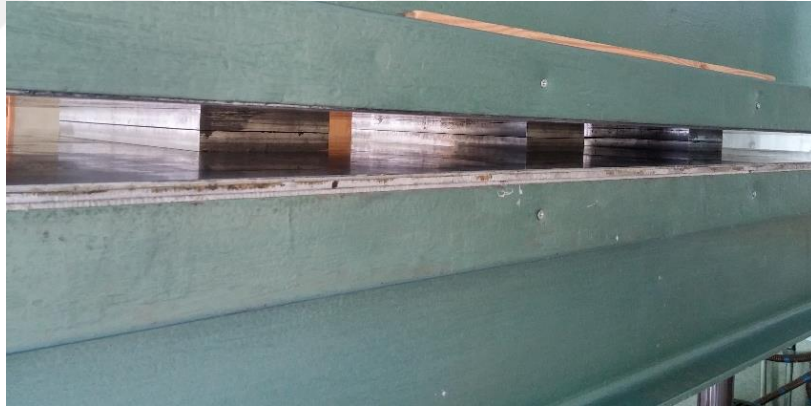
Şekil 3.3. Yoğunlaştırılmış örneklerin basınç altında soğutulması.
