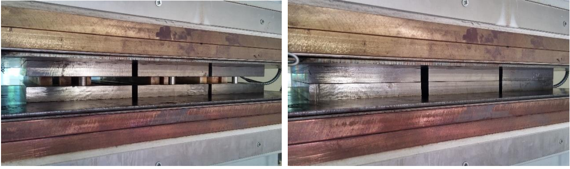
Şekil 3.2. Deney örneklerinin yoğunlaştırılması.
