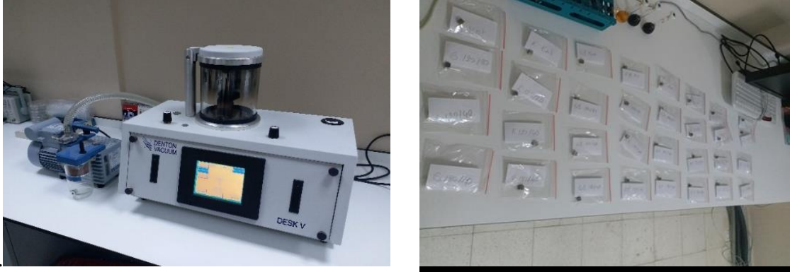
Şekil 3.9. Denton Vacuum Desk V makinası ile örnek yüzeylerinin altın metali ile kaplanması.
