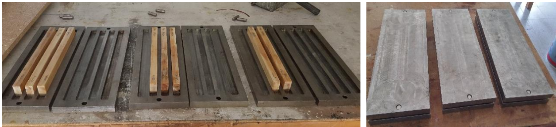
Şekil 3.1. Metal kalıplara yerleştirilmiş örnekler.
