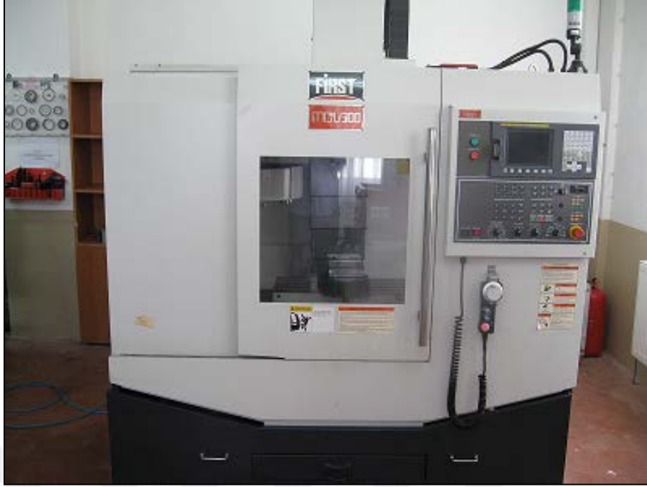
Şekil 3.5. FİRST marka MCV300 modeli üç eksenli CNC dik işleme merkezi.
