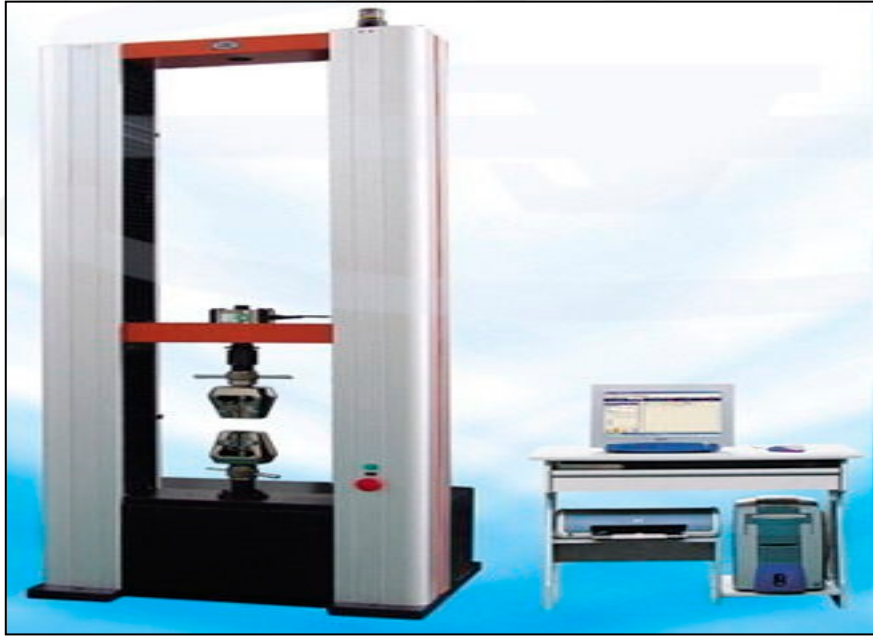
Şekil 3.6. Yükleme kapasitesi 5kN olan TIME GROUP INC. firmasının WDW-E 5kN serisi universal elektromekanik test cihazı.
