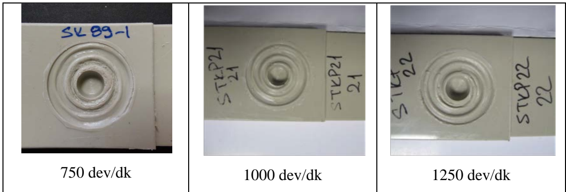
Şekil 4.18. T4 takımı ile birleştirilen numunelere ait kaynak bölgesinin üstten görüntüleri.
