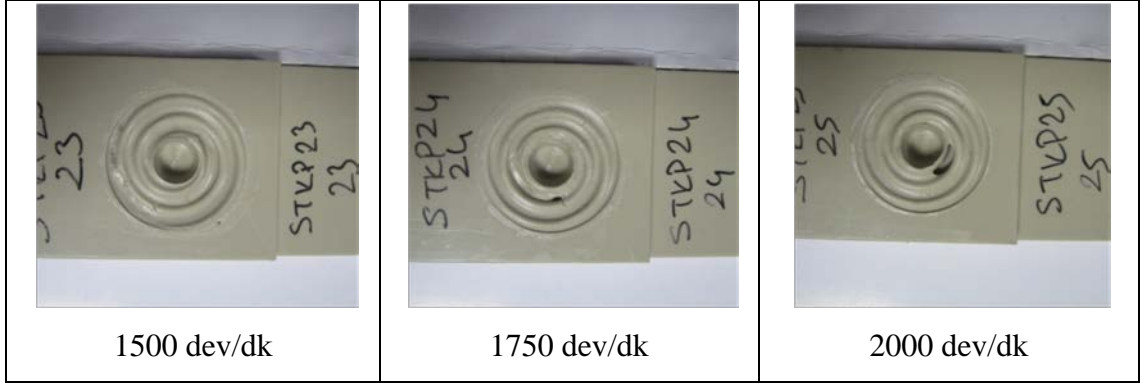
Şekil 4.18. (devam). T4 takımı ile birleştirilen numunelere ait kaynak bölgesinin üstten görünüşleri.
