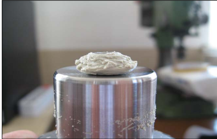
Şekil 4.38. T3 takımının karıştırıcı ucunda SKNK işleminden sonra biriken PP malzeme.
