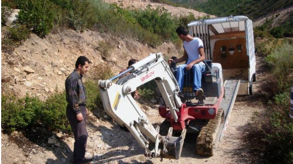
Şekil 2.10. BUROR Teras yapan mini ekskavatörün çalışma alanına indirilmesi.
