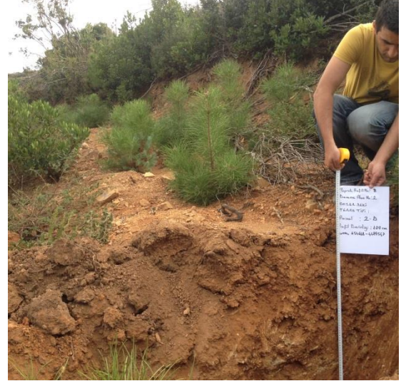
Şekil 2.22. 1 ve 2 Nolu Deneme parsellerinde açılan toprak profilleri ve horizonların tespiti.
