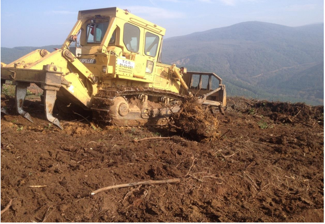
Şekil 2.7. Caterpillar D7 Dozer ile tarakla tam alanda makineli örtü temizliği.
