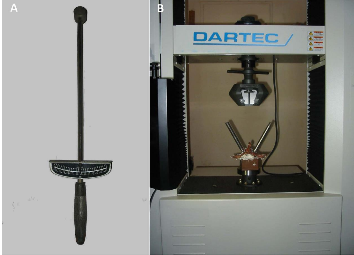
Şekil 2.A. Analog tork metre. B. Servohidrolik 600kN kapasiteli üniversal mekanik test makinası
