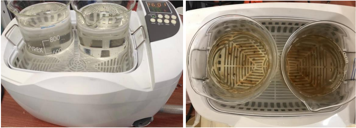
Şekil 2.5. Hazırlanan numunelerin ultrasonik banyoda karıştırılma işlemi.
