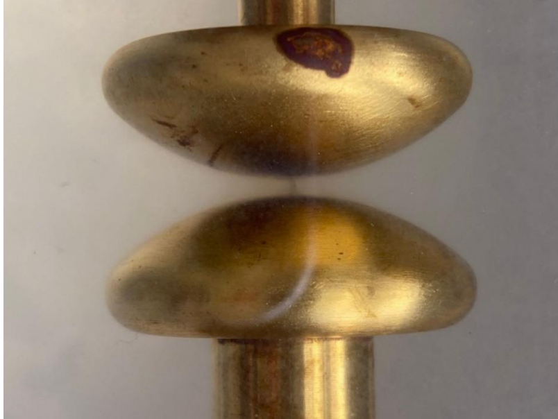
Şekil 3.6. Yağın konsantrasyon oranına bağlı deşarj yolunun görüntüsü.
