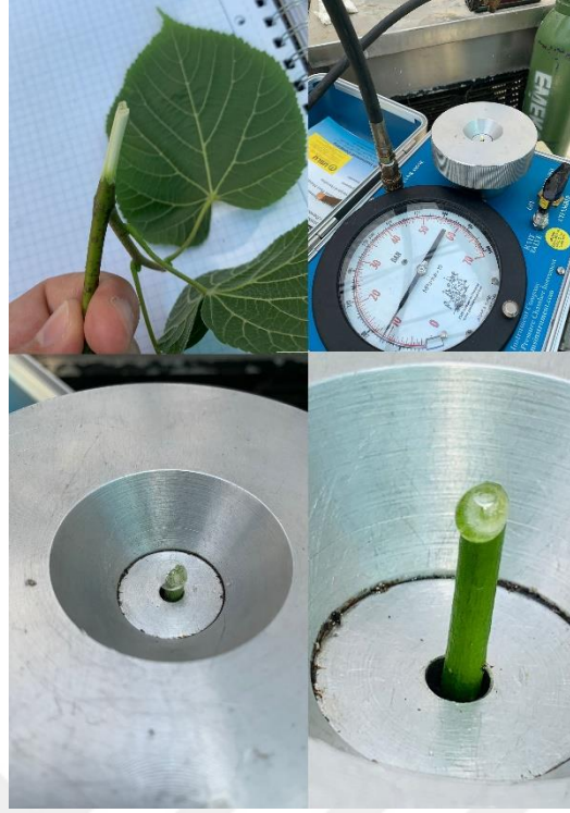
Şekil 3.5. Basınç odası tekniği ile bitki su potansiyelinin ölçülmesi.
