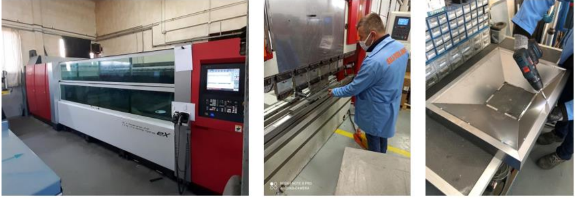
Şekil 3.16. Davlumbaz prototiplerinin oluşturulması, a) Lazer ile sac kesme, b) Sac şekillendirme, c) Montaj.
