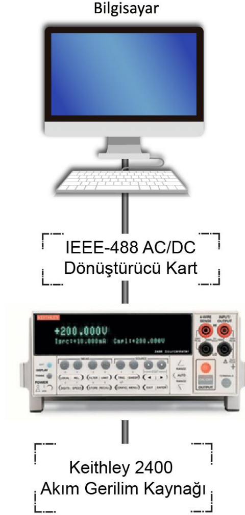
Şekil 3.9. Keithley 2400 akım-gerilim kaynağı ölçüm sistemi.
