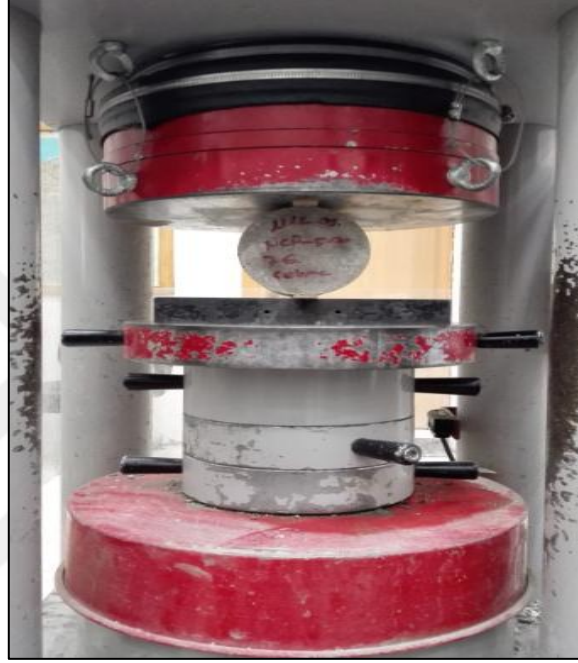
Şekil 2.19. Yarmada çekme deneylerinin yapılması.
