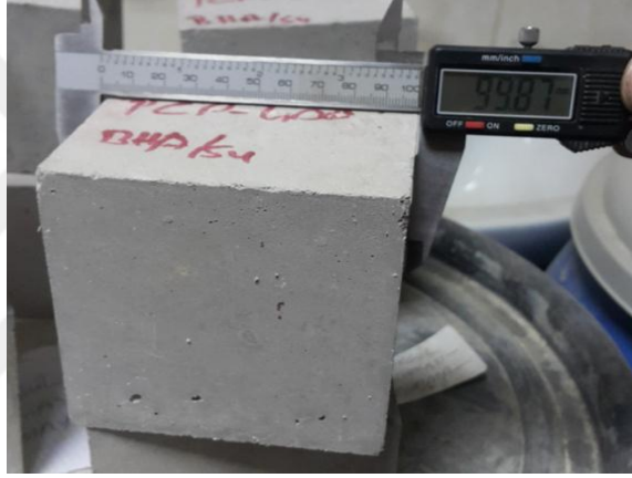
Şekil 2.15. Etüv kurusu numunelerin boyutların belirlenmesi.
