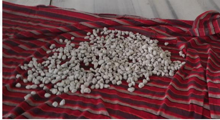
Şekil 2.11. Agregaların doygun kuru yüzey hale getirilmesi.
