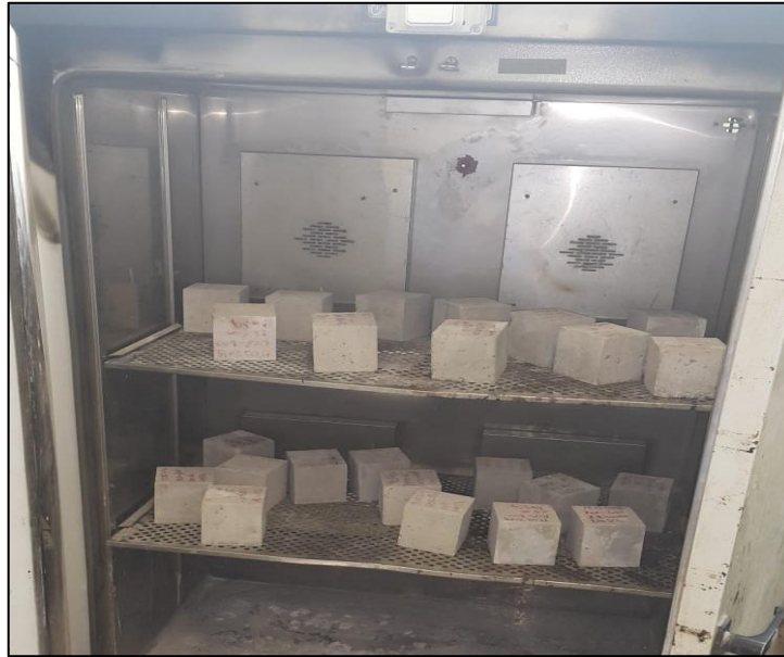
Şekil 2.23. Sülfat deneyinden sonra numunelerin etüve bırakılması.
