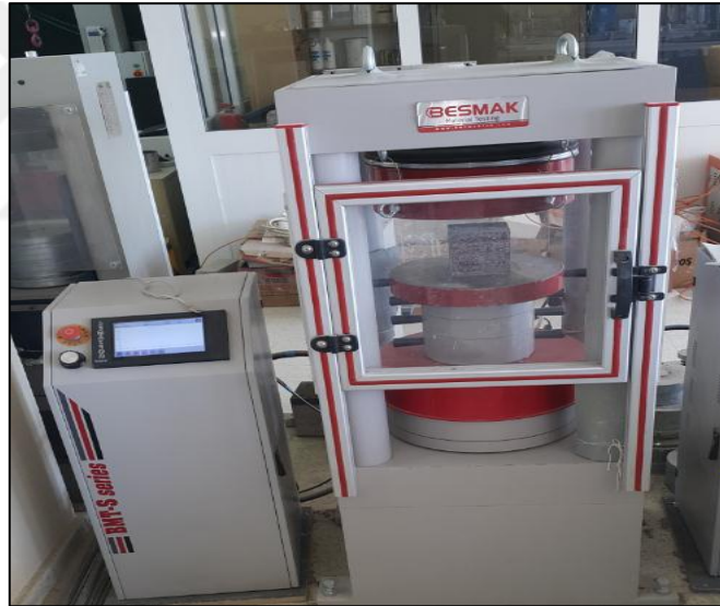
Şekil 2.16. Basınç dayanımı test cihazı.
