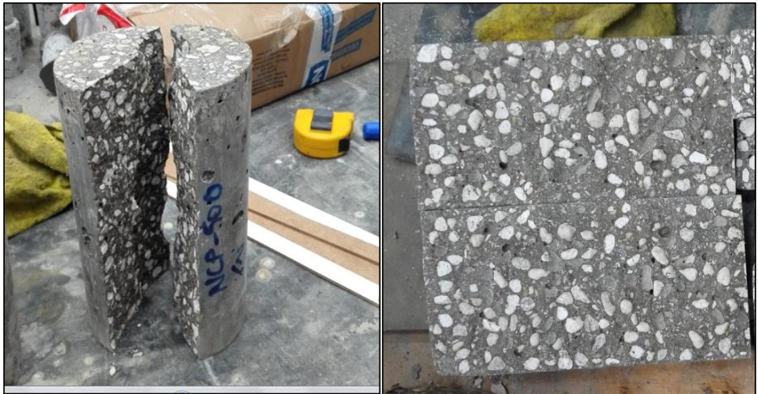
Şekil 2.20. Yarmada çekme dayanımı deyinde kırılan numunelere ait görüntüler.
