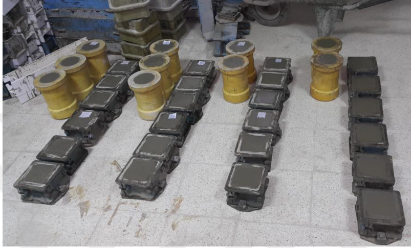
Şekil 2.13. Taze betonun kalıplara yerleştirilmesi.
