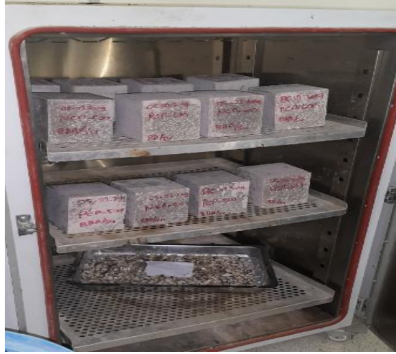
Şekil 2.14. Numunelerin etüve bırakılması.
