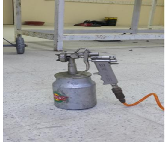
Şekil 2.5. Alttan hazneli boya tabancalı sistem.
