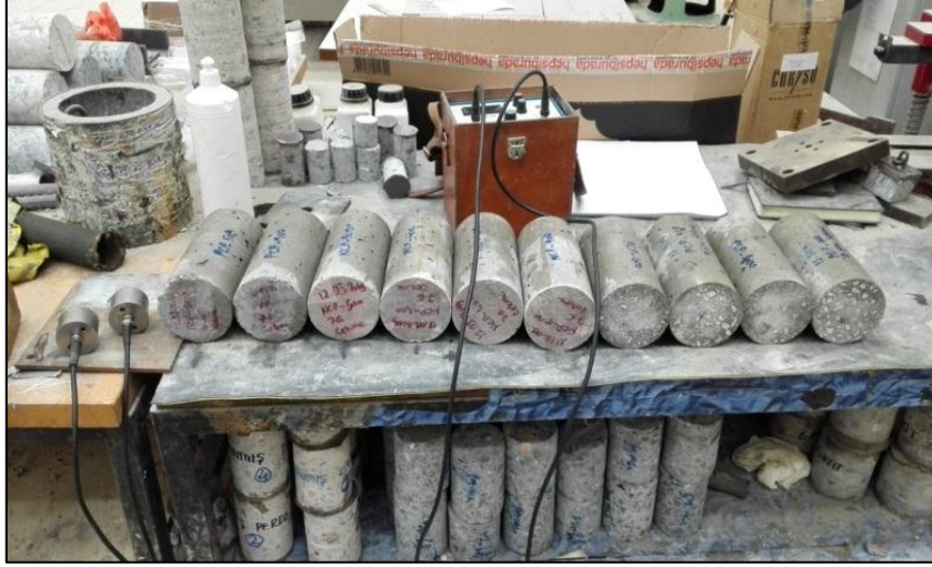
Şekil 2.21. Ultrases geçiş hızı deneyi.
