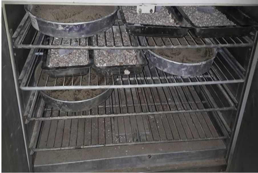
Şekil 2.9. Agregaların etüvde bekletilmesi.
