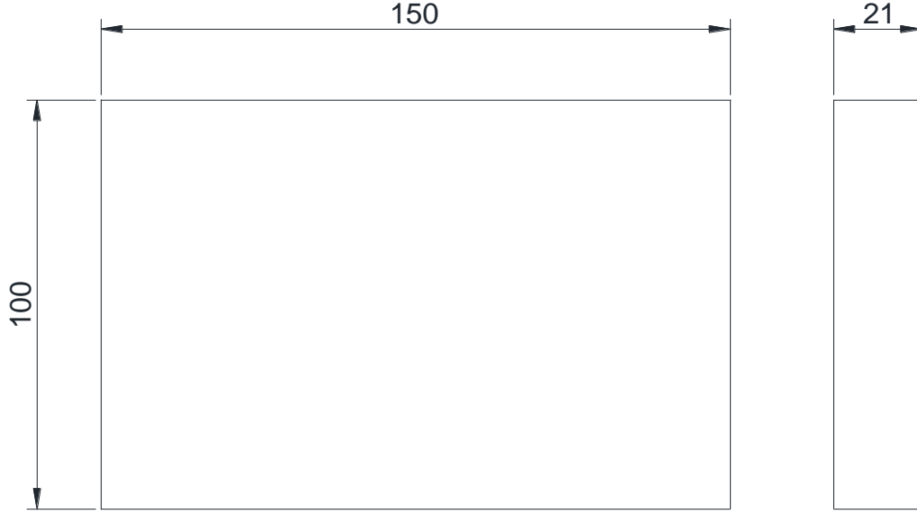
Şekil 7.1. Frezeleme deneylerinde kullanılacak numune boyutları.
