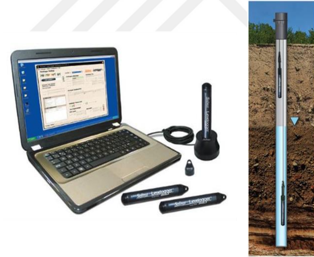
Şekil 2.8. Levelogger ve barologger cihazlarının bilgisayar ortamında kalibre edilmesi ve silindirin içerisine yerleştirilmesi.
