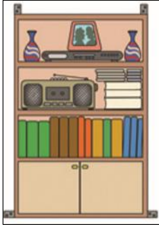
Şekil 3.10. Dolapların sabitlenmesi örneği.
