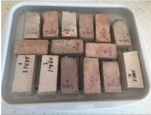
Şekil 2.57. a) 28 gün yaşında olan su emme deneyi, b) 90 gün yaşında olan su emme deneyi.
