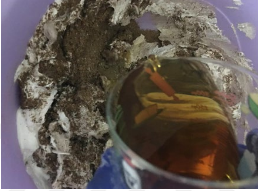
Şekil 6.7. Seri 3 numunesine ait harç karışımına diş budak suyunun ilave edilmesi.
