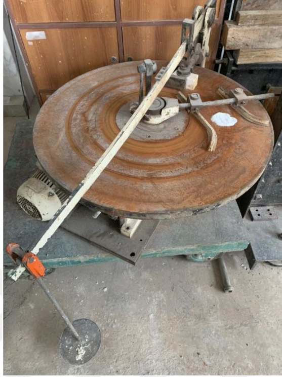
Şekil 2.62. Aşınma (Böhme) deneyinin yapılışı.
