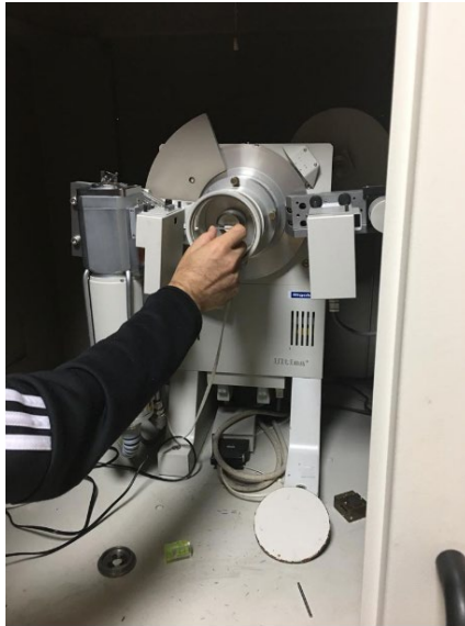
Şekil 2.65. a) Numunelerin X-RAY cihazına yerleştirilmesi, b) XRD analizinin yapılışı.
