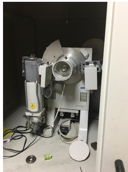
Şekil 2.65. a) Numunelerin X-RAY cihazına yerleştirilmesi, b) XRD analizinin yapılışı.
