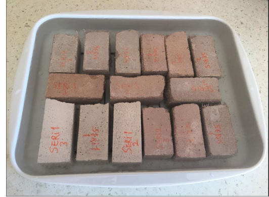
Şekil 2.57. a) 28 gün yaşında olan su emme deneyi, b) 90 gün yaşında olan su emme deneyi.
