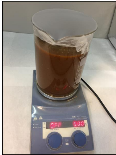
Şekil 2.1. 500 rpm'e ayarlanmış manyetik karıştırıcıdaki PRPLS.
