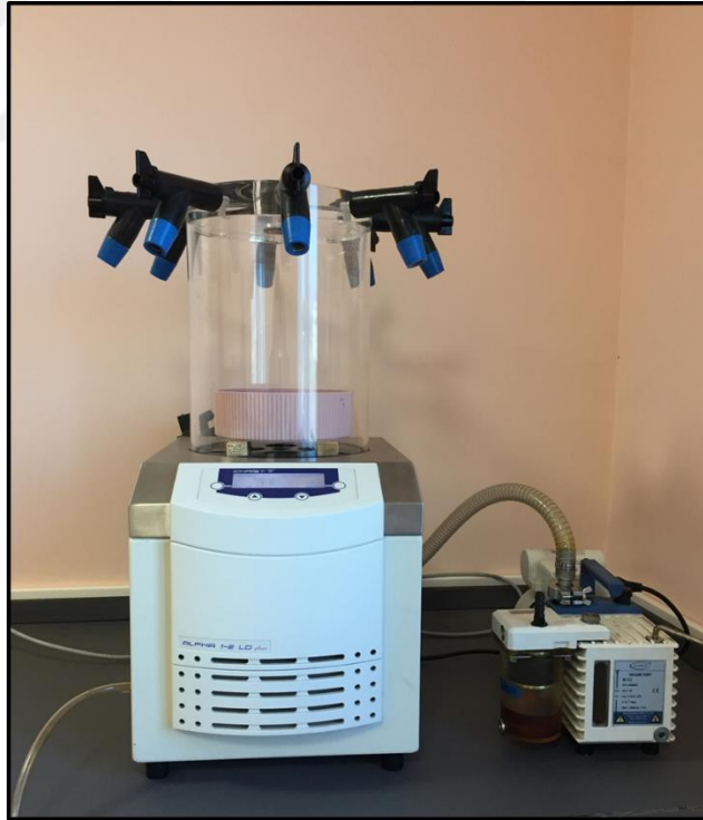
Şekil 2.3. Liyofilizatörde PRPLS toz ekstraktının elde edilmesi.
