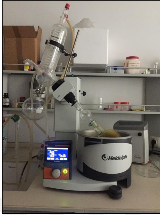
Şekil 2.2. Rotary evaporatörde PRPLS ekstraktının içindeki etil alkolün uçurulması.
