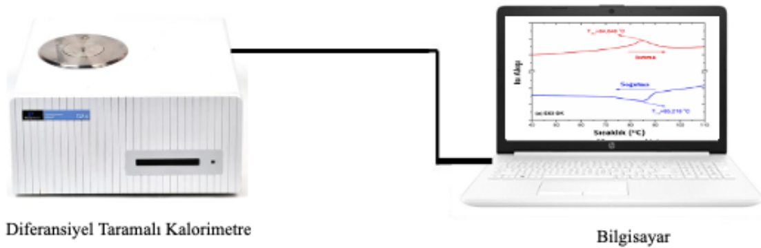
Şekil 5.6. Termal ölçümler için kullanılan deney düzeneği.
