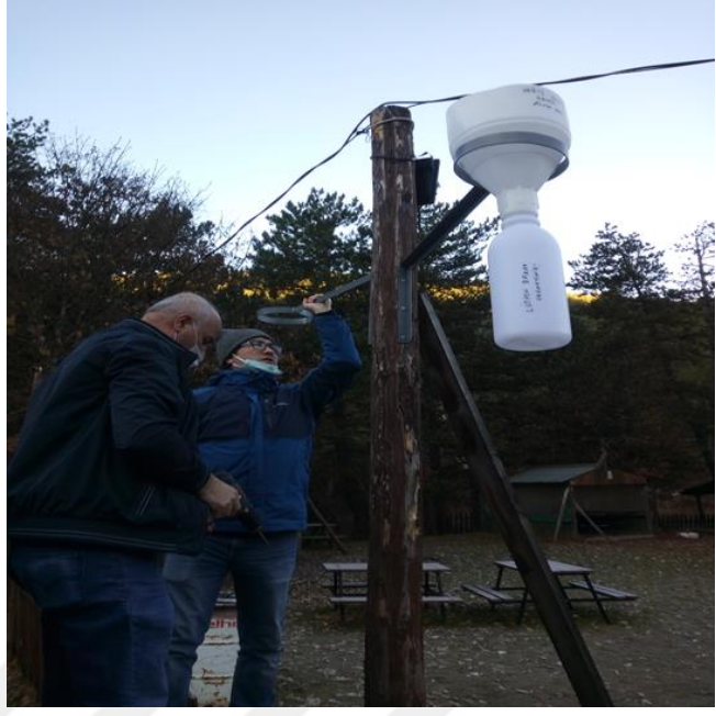
Şekil 2.7. Havzada yağış ölçerler ile yağış ölçülmesi.
