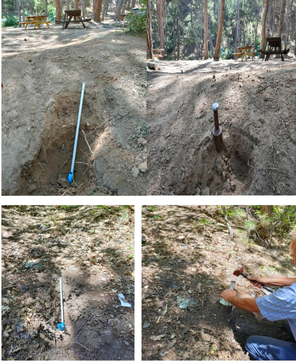
Şekil 2.4. Havzanın mesire ve orman alanında açılan toprak profili ve örnek alımı.
