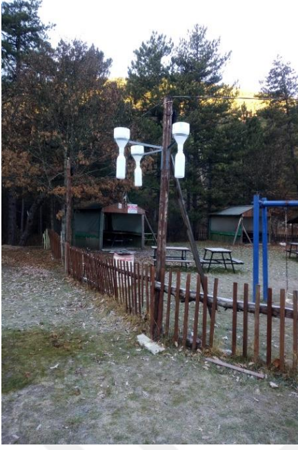
Şekil 2.7. Havzada yağış ölçerler ile yağış ölçülmesi.
