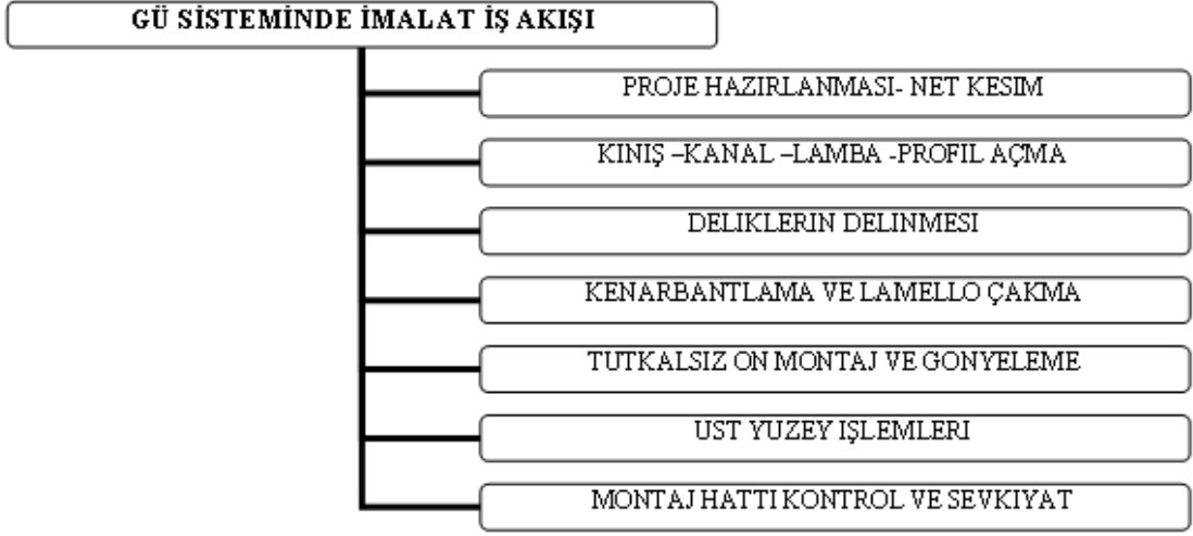
Şekil 3.1: GÜ sisteminde imalat akış prosesleri
