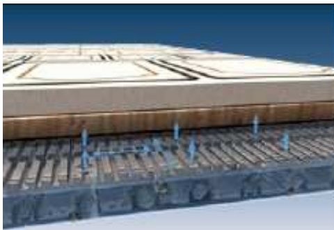
Şekil 3.16: İş Parçası ve Vakum İşlemi
