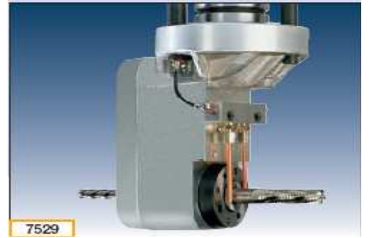
Şekil 3.13: Dikey ve Yatay Delik Ünitesi
