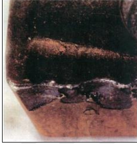
Şekil 2.18. Kesici takımda meydana gelen kırılma [23].
