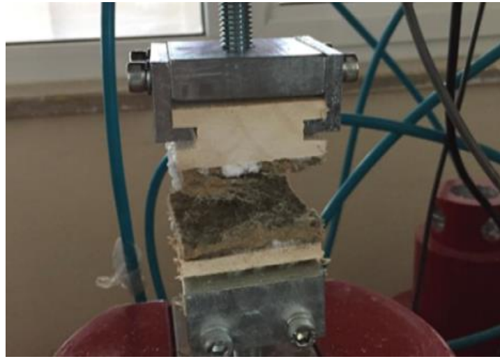
Şekil 4.9. Yüzeye dik çekme direnci deneyi sonucunda levha numunesi.
