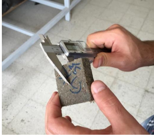
Şekil 3.12. Kalınlık artış oranı deneyi için numune ölçüm işlemleri.
