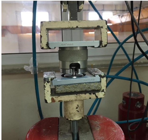
Şekil 3.19. Vida tutma direnci test düzeneği.
