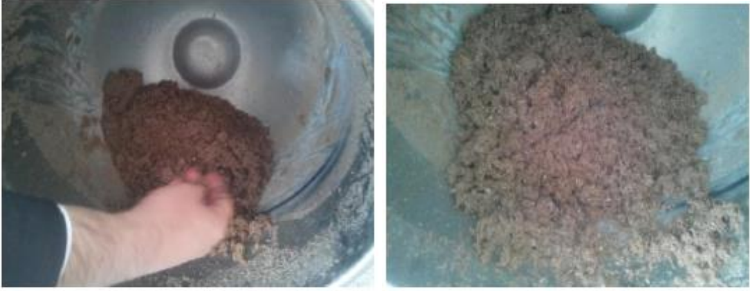
Şekil 3.7. Karıştırıcı yardımıyla levha karışımının hazırlanması.
