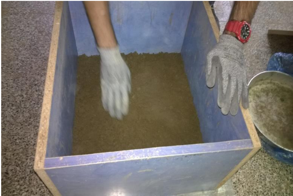
Şekil 3.8. Levha taslağının klavuz yardımıyla kalıba serilmesi.
