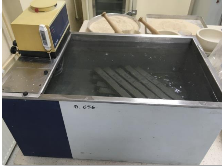
Şekil 3.13. Kalınlık artış oranı deneyinde kullanılan ısıtıcı su banyosu.
