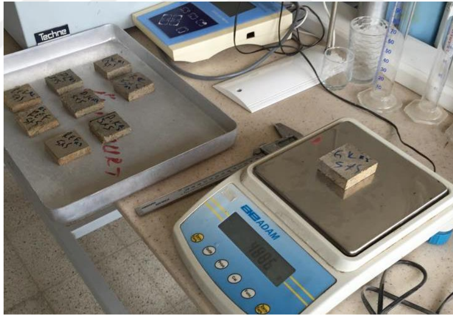
Şekil 3.11. Birim hacim ağırlık deneyi için numune ağırlıkların belirlenmesi.
