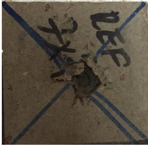
Şekil 4.11. Vida Tutma direnci deneyi sonucunda levha numunesi.
