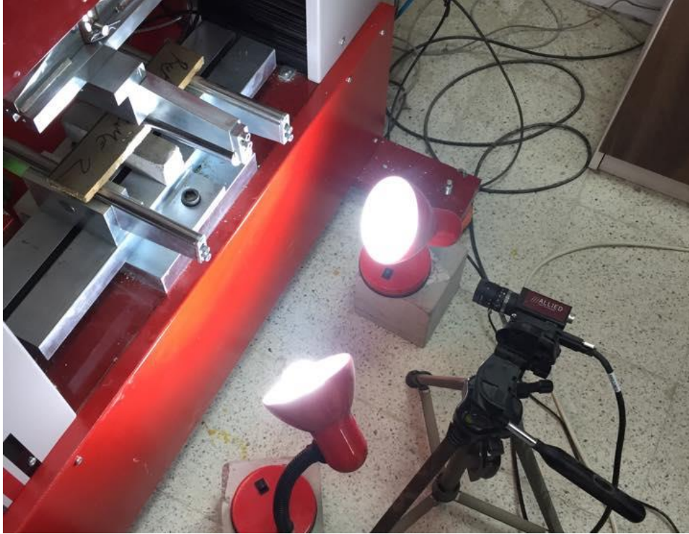
Şekil 3.17. Eğilme dayanımı deneyinde kullanılan üniversal test cihazı ve video ekstansometre.
