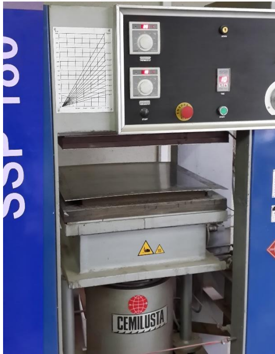
Şekil 3.10. Çimentolu lif levha üretiminde kullanılan endüstriyel pres.
