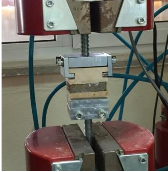
Şekil 3.18. Yüzeye dik çekme direnci test düzeneği.
