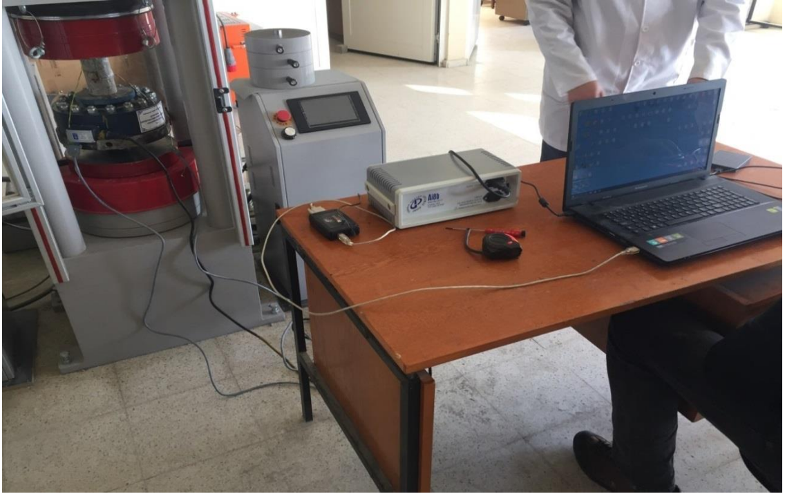
Şekil 3.2. Yeni numunelere basınç yüklemesi yapılması.
