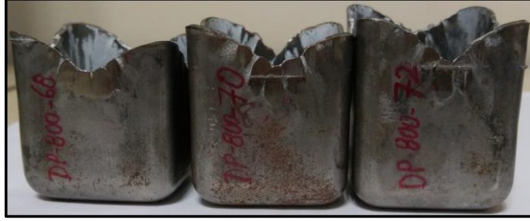
Şekil 4.7. DP800 kare derin çekilmiş malzemeler.
