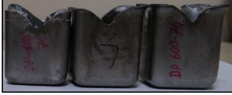
Şekil 4.6. DP600 kare derin çekilmiş malzemeler.
