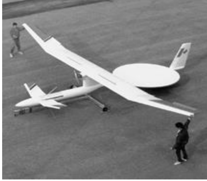
Şekil 1.8. SHARP firmasının mikrodalga enerjisi ile çalışan uçağı [43].
