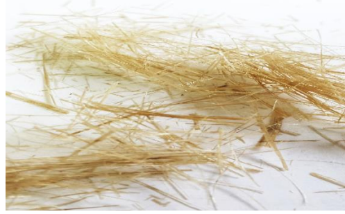
Şekil 2. Asfalt beton karışımlarda kullanılan doğal kenevir lifi
