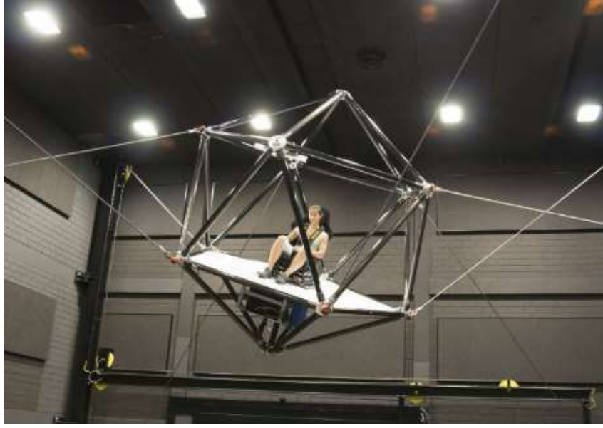
Şekil 1.2. Cablerobot hareket simülatörü [7].
