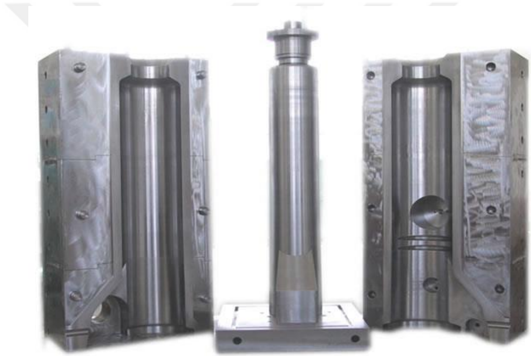
Şekil 2.47. Dişi erkek kalıp ve maça örneği [7].
