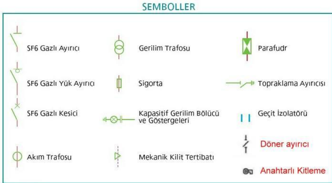
Şekil 2.24. Tek hat şemalarında kullanılan semboller.
